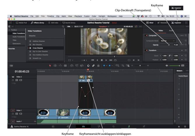
Mit Hilfe von Keyframes kann über den Verlauf des Clips die "Opacity" geregelt werden. Dazu fährt man mit dem Abspielkopf an die Stelle an der ein Opacity-Wert eingegeben werden soll, klickt auf das Keyframesymbol im "Inspector" und ändert den Wert.
