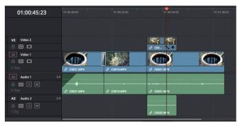
Um zwei Clips zu überblenden, kann man auch weitere Videospuren nutzen. Dazu zieht man einen Clip z.B. auf **Videospur 2** (V2) über den Clip zu dem man überblenden möchte. Weitere Videospuren werden erzeugt, wenn ein Clip über die oberste Spur gezogen wird. Dabei wird automatisch Videospur 3,4,... erzeugt.
