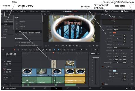
Am oberen Rand des Programmfensters ist über "Effects Library" und dort unter "Toolbox" der Texteditor "Titles" aufrufbar. Von dort aus zieht man z.B. "Text" in die Timeline. Dort wird ein Textclip erzeugt Klickt man diesen an, erscheinen rechts im "Inspector" die Textbearbeitungsmöglichkeiten. Das Inspector-Fenster kann bei Bedarf über das Pfeilsymbol (oben rechts) nach unten erweitert bzw. minimiert werden.
